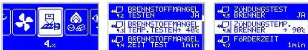
**4.2 - Prüfen des Brennstoffmangels** – der Parameter ermöglicht das Prüfen des Brennstoffmangels einzuschalten. Nach dem Einschalten dieser Funktion geht der Regler in den Modus BETRIEB über und beginnt die Wassertemperatur im Kessel zu überwachen. Wenn sie bis auf den unter dem Parameter
