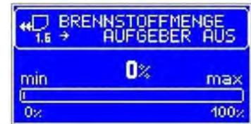
**⚠ ACHTUNG!** Die minimale Brennstoffmenge, die mit dem Drehknopf eingestellt werden kann, beträgt so viel wie ein unter dem Benutzer-Parameter „Min. Brennstoffmenge“ eingestellter Wert.
