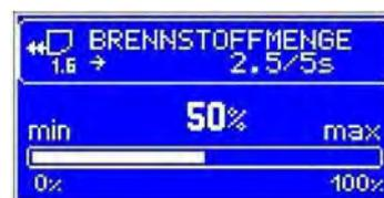
Im oben angeführten Beispiel wurde der Drehknopf der Brennstoffzuführung auf den Wert 50% eingestellt, und der Brennstoff wird durch 2,5 Sekunden in 5 Sekunden dauernden Zyklen (das Intervall zwischen den Einschaltungen des Brennstoff-Förderers beträgt dann 2,5 Sekunden) zugeführt. Die dargestellten Werte ergeben sich aus der darunter angeführten Abhängigkeit:
