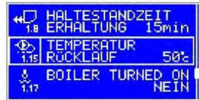
**1.17 - Kessel eingeschaltet** – dieser Parameter informiert, ob der Kessel eingeschaltet ist und ermöglicht den Kessel ein- oder auszuschalten.
