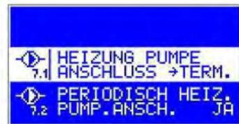
**7.1 - Einschaltmodus der Pumpe ZH** – dieser Parameter bestimmt, wie die Pumpe ZH aktiviert wird. Ist der Wert auf „THERMOSTAT“ gesetzt, bedeutet, dass die Pumpe ZH nur bei kurzgeschlossenen Kontakten der Raumthermostate und Notfällen (z.B. Überhitzung des Kessels). Ist der Wert auf „AUTO“ gesetzt, bedeutet dass, die Pumpe ZH unabhängig von dem Raumthermostat arbeitet.
