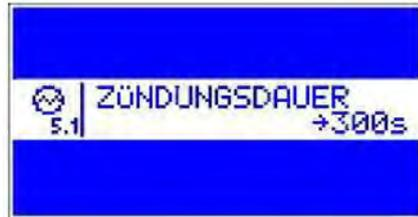
**5.1 - Dauerzeit der Brennstoffzündung** – der Parameter bestimmt, wie viel Zeit es nach dem Anschluss der Glühkerze (des Zünders) nötig ist, um den Brennstoff anzuzünden.
