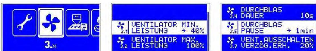
**3.1 - Modulation der Gebläseleistung während der Anzündung** – wenn dieser Parameter auf Wert JA eingestellt wird, wird dann die Modulation der Gebläseleistung während der Brennstoffanzündung eingeschaltet.
