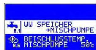
Der Regler verfügt über einen zusätzlichen Pfad für Warmwasseraufbereitung. Weil es nicht in jedem Heizungs-Umlauf einen Warmwasserspeicher und eine Ladepumpe gibt, ist es möglich, den Umlauf auszuschalten oder ihn zur Steuerung einer Mischpumpe für Rücklaufwasser im Kessel einzusetzen.
