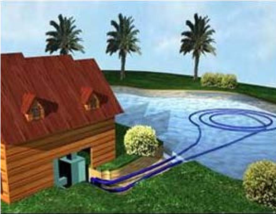
Das Oberflächenwasser (Fluss, See) wird als Heiz-/Kühlquelle der Oberflächenwasser-Wärmepumpe betrachtet. Die Wasserpumpe saugt das Wasser aus dem Fluss oder See direkt in die Wärmepumpe. Eine andere Methode ist, dass die Spule im Fluss oder See installiert wird, um Wärme auszutauschen.
