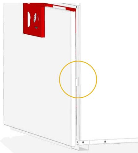
Nachdem Sie die Verkabelung abgeschlossen haben, richten Sie bitte die Position der Schnalle an der Platte mit der Position des Lochs an der Seitenplatte aus und schnallen Sie sie in die Platte
